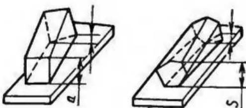
Т а б л и ц а 9 —Скручивание квадратных и шестигранных тянутых прутков намотанных в бухты
